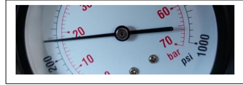
Cilindro # 2 valor de compresión 260 psi, 16 bar
