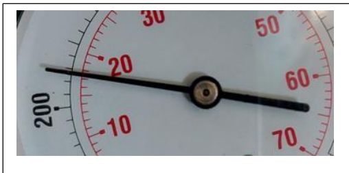
Cilindro # 3 valor de compresión 250 psi, 18 bar
