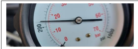
Cilindro # 3 valor de compresión 240 psi, 16 bar
