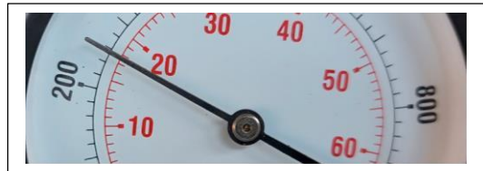
Cilindro # 4 valor de compresión 260 psi, 18 bar
