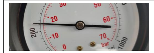
Cilindro # 4 valor de compresión 240 psi, 16 bar
