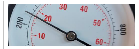
Cilindro # 4 valor de compresión 260 psi, 18 bar
