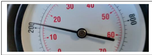
Cilindro # 3 valor de compresión 220 psi, 15 bar
