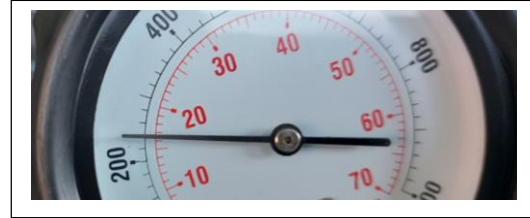
Cilindro # 2 valor de compresión 240 psi, 16 bar
