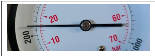
Cilindro # 3 valor de compresión 240 psi, 16 bar
