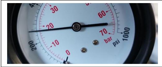
Cilindro # 1 valor de compresión 260 psi, 18 bar
