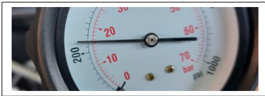
Cilindro # 3 valor de compresión 240 psi, 16 bar
