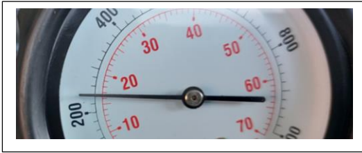
Cilindro # 1 valor de compresión 240 psi, 16 bar
