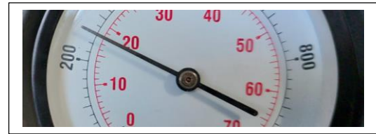
Cilindro # 4 valor de compresión 260 psi, 18 bar
