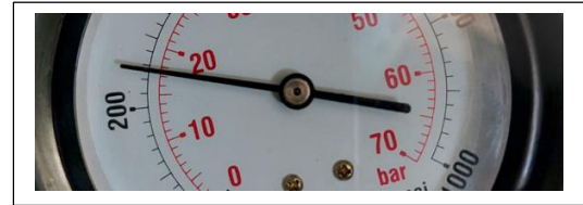
Cilindro # 2 valor de compresión 260 psi, 17 bar
