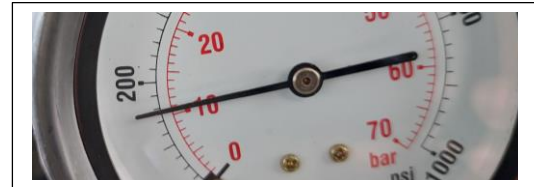
Cilindro # 2 valor de compresión 160 psi, 11 bar
