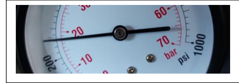
Cilindro # 2 valor de compresión 260 psi, 16 bar
