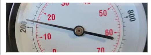
Cilindro # 1 valor de compresión 230 psi, 16 bar
