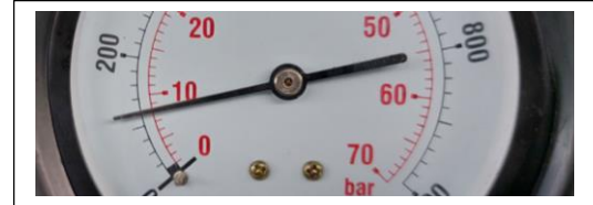
Cilindro # 4 valor de compresión 100 psi, 8 bar
