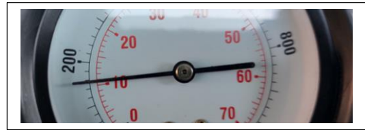
Cilindro # 2 valor de compresión 180 psi, 11 bar
