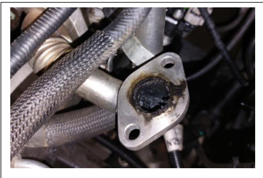
Ducto de la válvula EGR al cuerpo de aceleración con hollín y aceite
