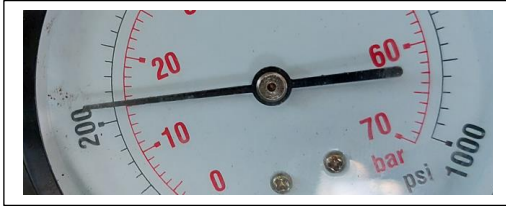
Cilindro # 1 valor de compresión 210 psi, 15 bar
