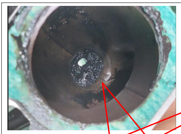
Contaminante encontrado en el tubo de admisión
