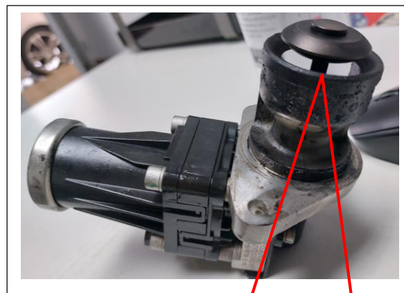
Válvula EGR atascada en posición abierta
