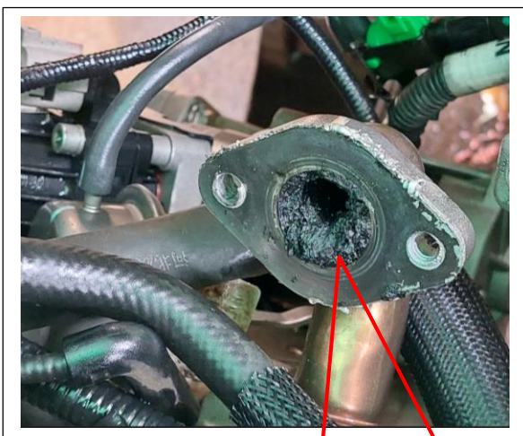
Tubo de la válvula EGR obstruido
