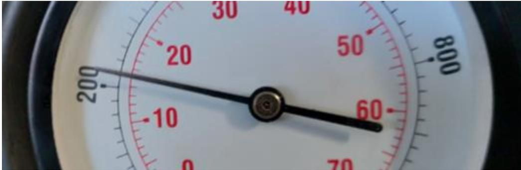
15 bar, Cilindro # 4 valor de compresión 260 psi, 18 bar
