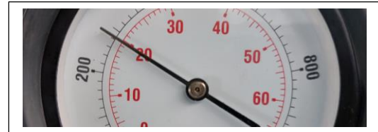
Cilindro # 2 valor de compresión 280 psi, 19 bar
