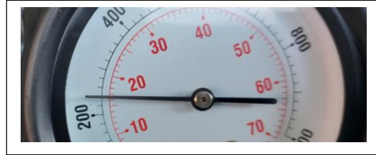
Cilindro # 2 valor de compresión 240 psi, 16 bar
