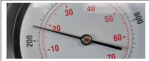
Cilindro # 1 valor de compresión 260 psi, 18 bar
