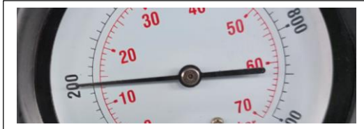
Cilindro # 3 valor de compresión 200 psi, 14 bar
