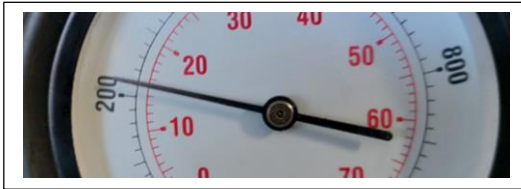
Cilindro # 3 valor de compresión 220 psi, 15 bar
