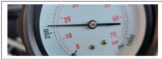
Cilindro # 3 valor de compresión 240 psi, 16 bar
