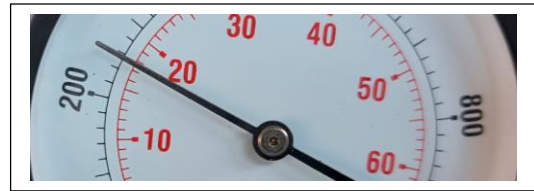
Cilindro # 4 valor de compresión 260 psi, 18 bar
