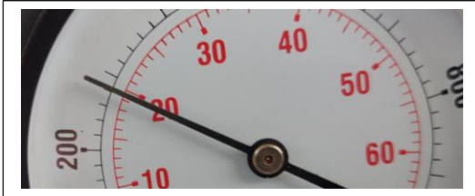
Cilindro # 1 valor de compresión 280 psi, 19 bar
