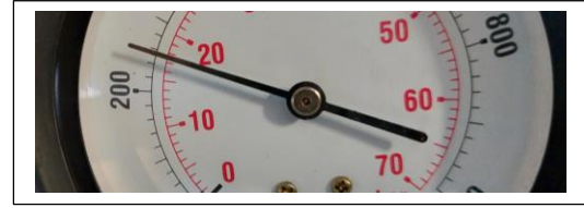
Cilindro # 2 valor de compresión 260 psi, 11 bar
