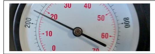
Cilindro # 4 valor de compresión 260 psi, 18 bar
