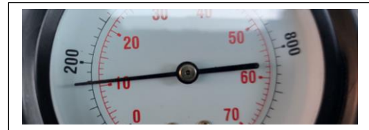
Cilindro # 2 valor de compresión 180 psi, 11 bar
