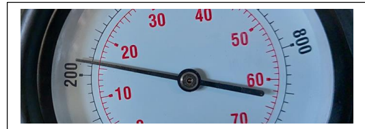
Cilindro # 4 valor de compresión 230 psi, 16 bar
