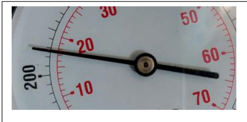
Cilindro # 3 valor de compresión 250 psi, 18 bar
