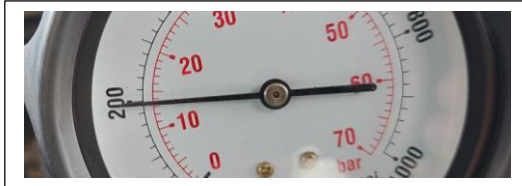
Cilindro # 3 valor de compresión 200 psi, 14 bar
