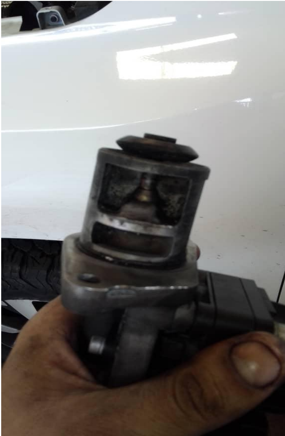
VALVULA EGR DAÑADA
