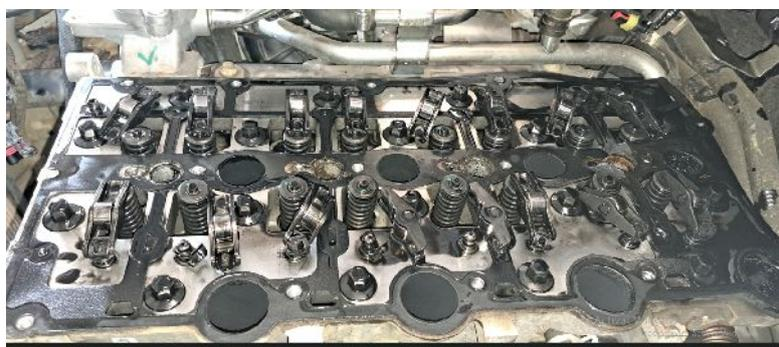
**Operación de sincronización y desmontaje de tapa válvula**
