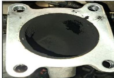
Cuerpo de Aceleración contaminado de Carbón y aceite de motor
