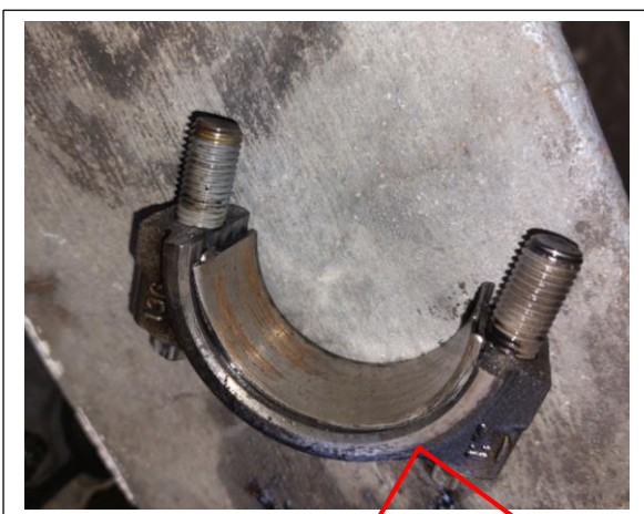
Tapa de biela y cojinete de biela del cilindro #1 fundida
