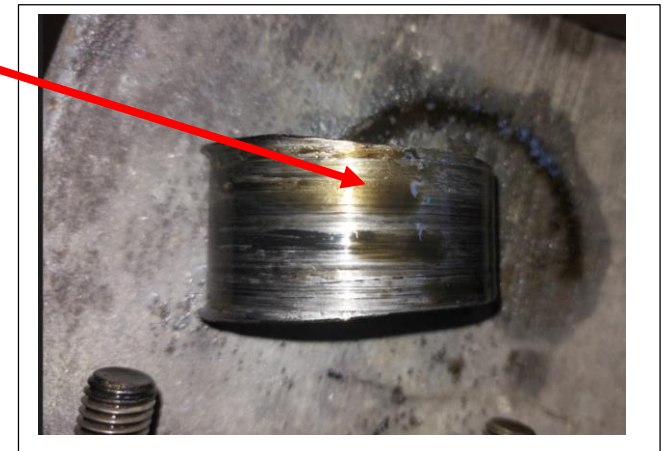
Muñequilla del cigüeñal del cilindro #1 fundida
