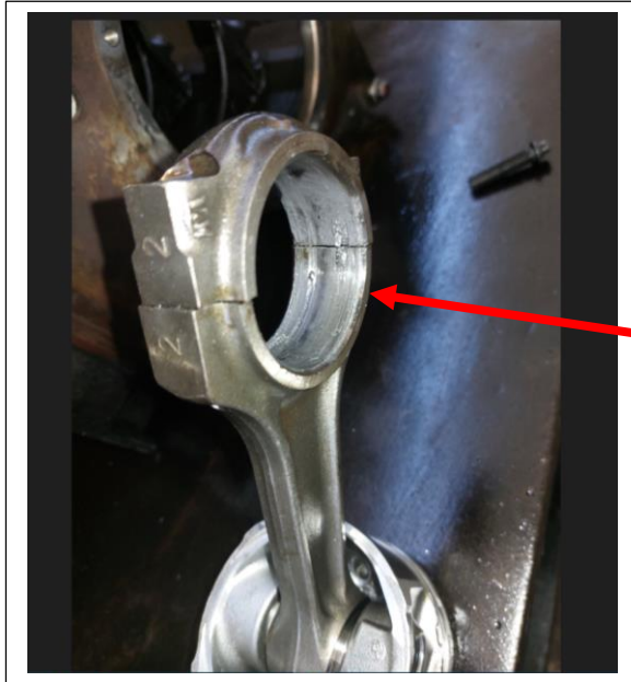
Brazo biela del cilindro #2 fundida, el cojinete giro arrastrando material de la biela
