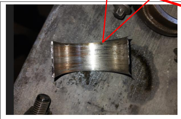
Cojinete de la biela del cilindro #1 fundida
