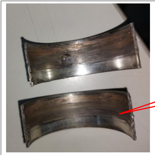
Cojinete de la biela del cilindro #2 fundida
