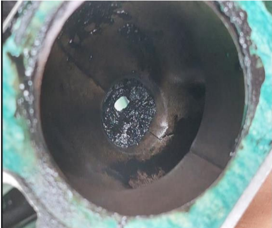
Contaminante encontrado en el tubo de admisión
