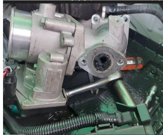
Contaminante encontrado en el tubo de admisión
