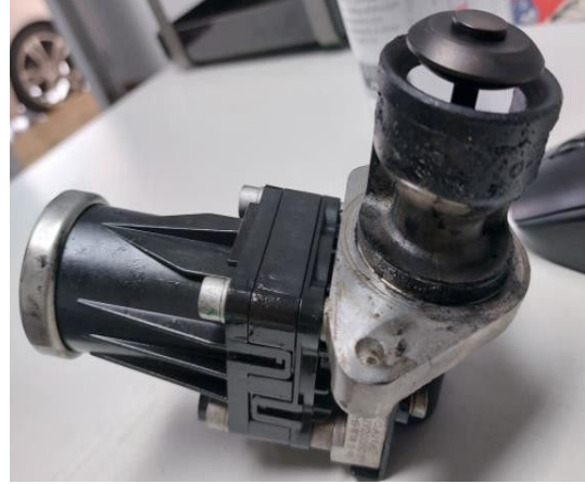
Válvula EGR atascada en posición abierta
