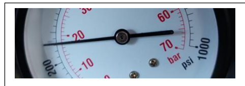
Cilindro # 2 valor de compresión 260 psi, 16 bar
