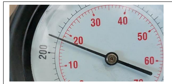
Cilindro # 4 valor de compresión 260 psi, 16 bar
