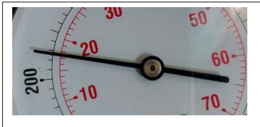
Cilindro # 3 valor de compresión 250 psi, 18 bar
