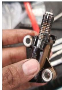
En la parte inferior del motor existe residuos de contaminación de aceite mas no se encuentra emulsionado. En el dispositivo OCV fue revisado y no existen evidencias de mal funcionamiento tal como se muestra en las siguientes fotos:
