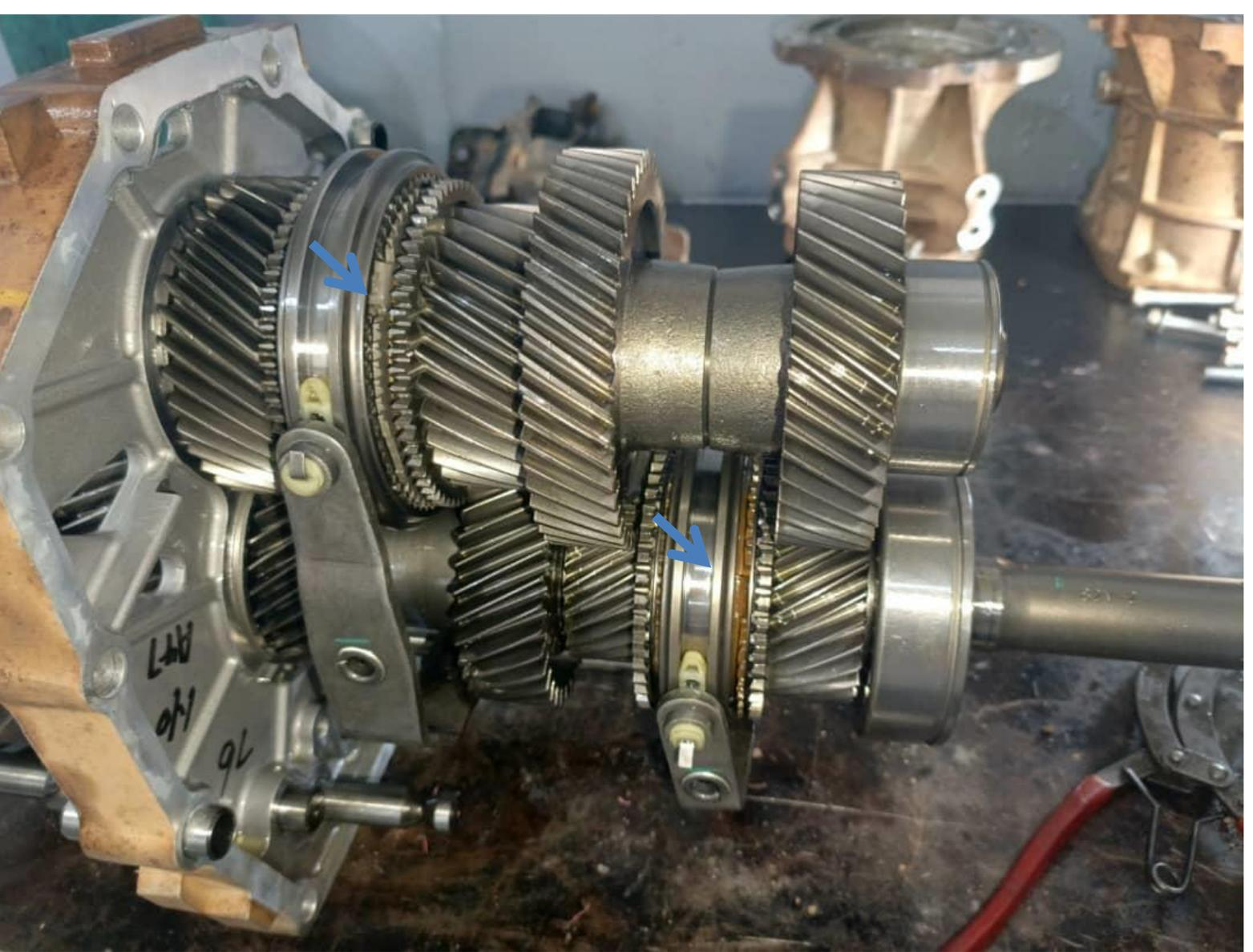
Se puede apreciar cómo el sincrónico de abajo presenta una coloración más oscura a la del sincrónico superior, lo que nos indicaría un posible recalentamiento el mismo pudo ser ocasionado por un exceso de rose.
