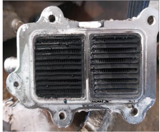
Cooler de la válvula EGR contaminado
