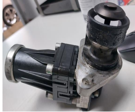
Válvula EGR atascada en posición abierta
