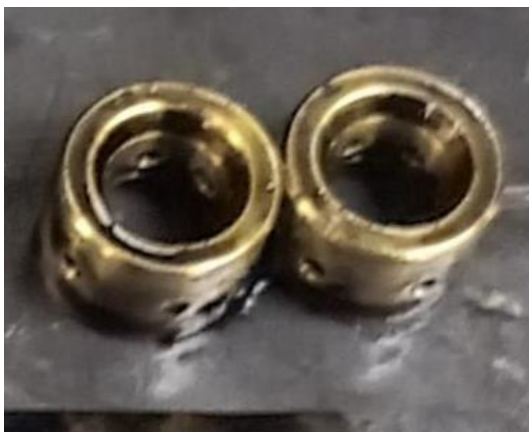
Anillos Rayados y Orificios Tapados
