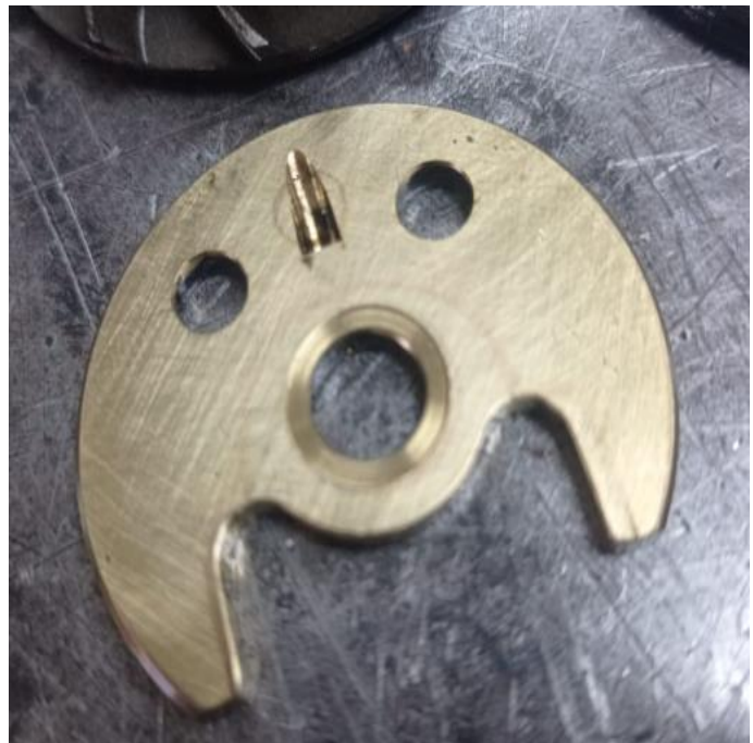
Desgaste en la Arandela (Plato)
