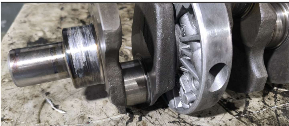
Cigüeñal afectado por problemas de lubricación.
