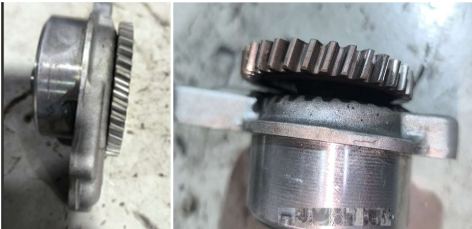
Bomba de aceite en malas condiciones
