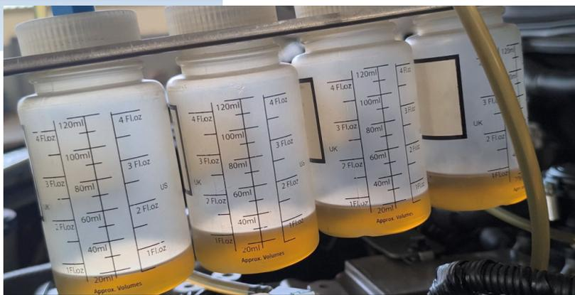
Medición de retorno con equipo YDT donde se aprecia diferencia de retorno entre inyectores.
