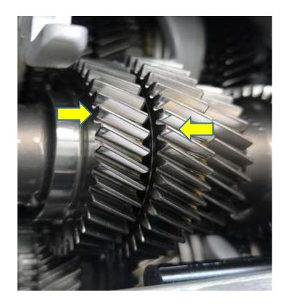
Rueda dentada con desgaste irregular, adicionalmente se adjunta videos de sonido irregular de transmisión
