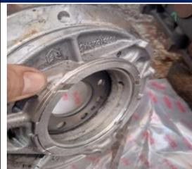
ENSAMBLE TRASERO CON DEGASTE EN EL COJINETES Y AXIALES
