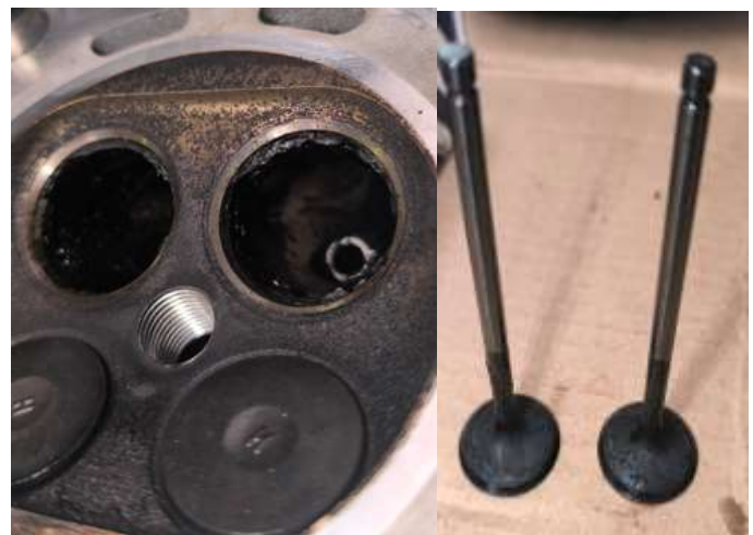
Asiento de válvulas con exceso de carbón
