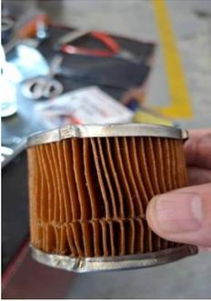
FILTRO DE ACEITE SE REALIZO CORTE PARA VERIFICAR ESTADO INTERNO. SE EVIDENCIA RESTOS DE PARTICULAS MUY PEQUELAS DE METALES Y SATURACION INTERNA, OLOR A GASOLINA.
