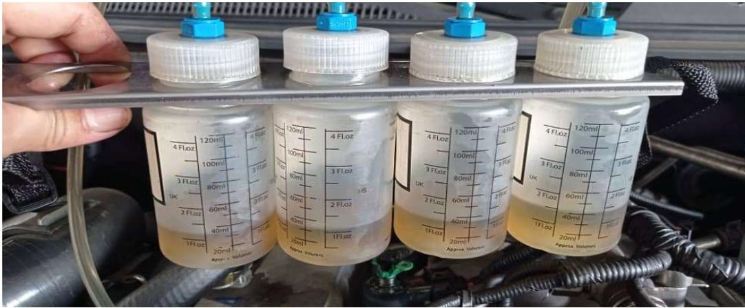
A ESTA UNIDAD SE LE REPARA EL MOTOR SE LE INSTALAN INYECTORES NUEVO Y SE HACE PRUEBA DE CARRETERA LA UNIDAD NO PASA DE 120KM/H SE INSTALAN OTROS INYECTORES Y MEJORA LA CONDICION
